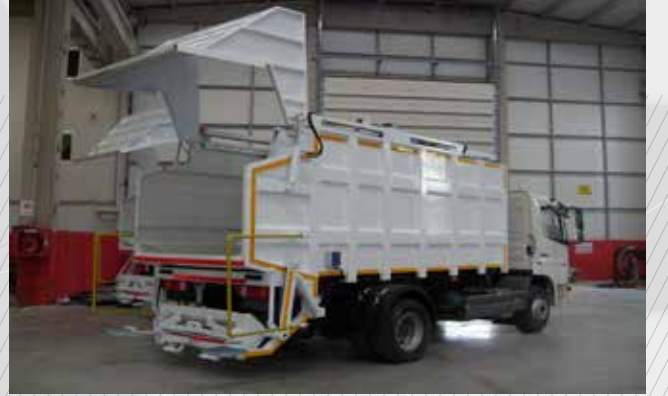
MONOVOLUME ÜSTTEN YÜKLEMELİ ÇÖP KAMYONU MONOVOLUME TOP LOADING WASTE TRUCK
