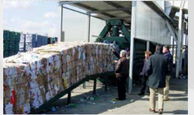
AYIRMA SONUCU PRESLEME, BALYALAMA SİSTEMİ
