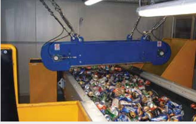
ALUMİNYUM, DEMİR VB. ATIKLARI MAGNETİK AYIRMA VE PRESLEME
