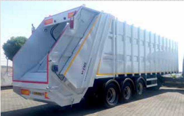
ÇEKİCİDEN BAĞIMSIZ MOTORLU PRESLEME SİSTEMİ
